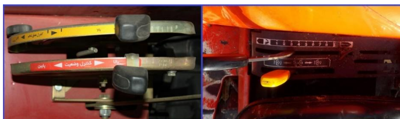
شکل ۴- اهرم هیدرولیک کنترل عمق شخم
