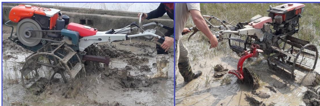
شکل ۲- کاربرد چرخ‌های فلزی در شخم و گل‌خراشی (گل‌آب کردن) (اصلی)
