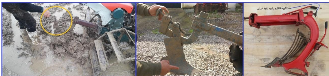
شکل ۶- دستگیره تنظیم زاویه نفوذ عامل خاک‌ورز (اصلی)
