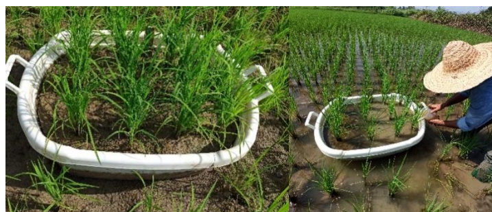
شکل ۱- لایسیمتر کار گذاشته شده در شالیزار برای اندازه‌گیری تبخیر و تعرق واقعی برنج
