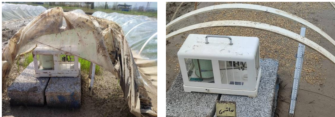
شکل ۱- دستگاه دمانگار در داخل خزانه برنج رقم هاشمی (اصلی)
