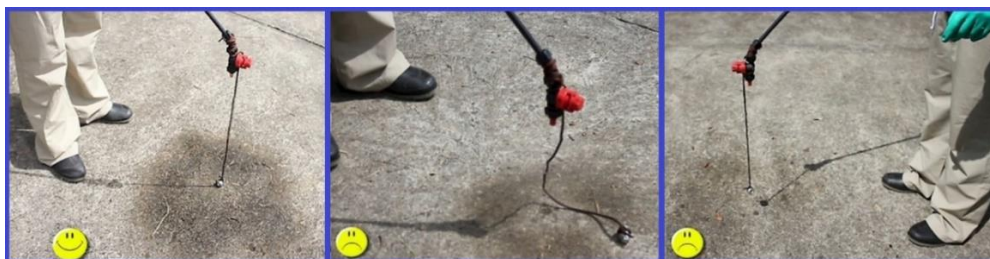
شکل ۹- استفاده از ریسمان وزنی ثابت نگهداشتن ارتفاع (ایترنت)
