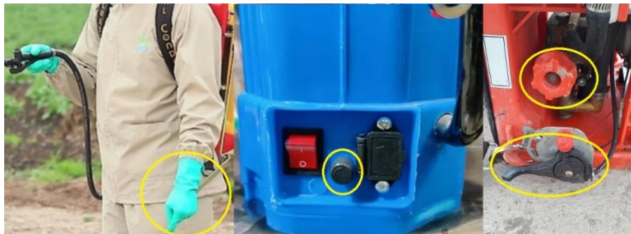
شکل ۳- نحوه‌ی تنظیم فشار در سمپاش‌های پشتی (راست: موتوری- وسط: شارژی- چپ: دستی) (ایترنت)
