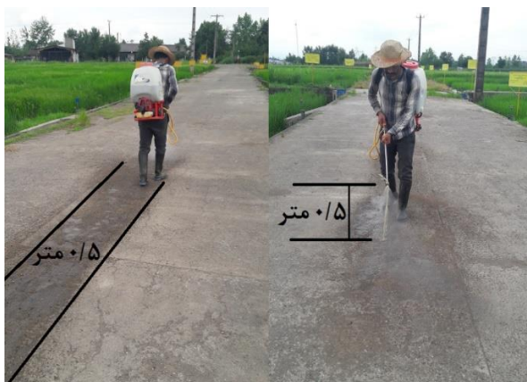
شکل ۸- ارتفاع نازل و عرض نوار پاشش (اصلی)
