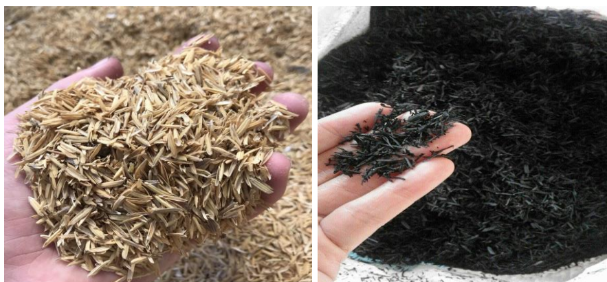
شکل ۲- پوسته برنج (تصویر سمت چپ) و زغال زیستی پوسته برنج (تصویر سمت راست)
