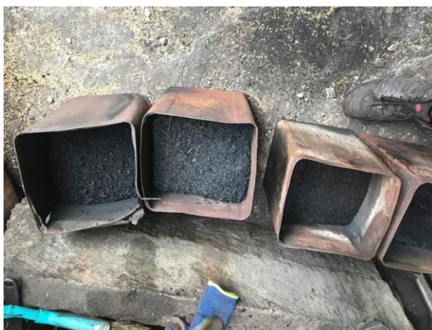
شکل ۵- خروج زغال تولیدی پس از خنک‌سازی از کوره
